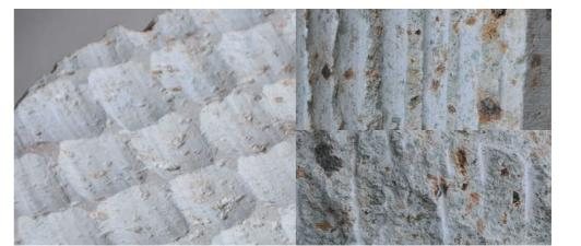
工具にゆだねたテクスチャー 石の表面加工のバリエーションは 少ない。ディスクグラインダーで 撫でるように削ると、ワッフルの ような表情になった。経年変化も 楽しめると考える。
