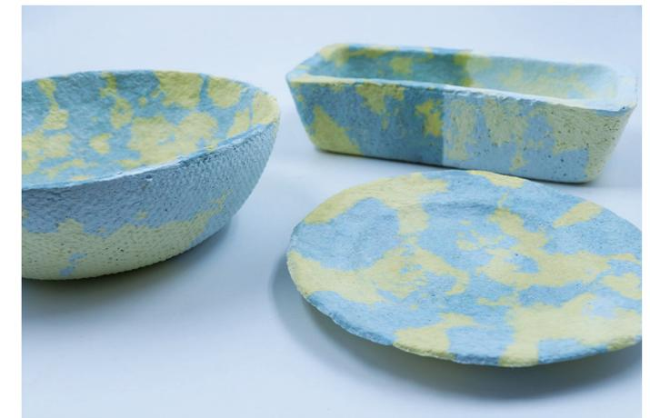
パルプモールドにロウ引きをしたことで、紙以上の強度と見た目以上の軽さ、独特な風合いが生まれる。そのモノとしての魅力に可能性を感じ、紙とロウの組み合わせや形を追求した。パルプモールドの素となる紙の素材には、レシートや FAX として利用され、リサイクルできずに燃えるゴミとして廃棄されてしまう感熱紙を使用。Thermal Wax Pulp mold というタイトルで、感熱紙からできたパルプモールドの器を製作。器の形は同じだが、それぞれに柿渋やロウ引き着色の度合いを調整し、個性を纏わせた Origin Pulp。色付き感熱紙2色を組み合わせるパルプモールドした器にロウ引きを施し、2色の模様とロウ引きしている面としていない面、様々な表情を追うことができる Mixing Thermal の2種類を展開した。
