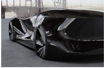
このデザインの最大のポイントはサイド面の肉体的な面と骨格的な線が生み出す複雑なうねりにある。フロントフェンダー後ろとリアフェン ダー前にある2つの Z 型の造形とそのうねりがぶつかり合う真ん中の複雑な面構成が、実際の情景の中で何重にも表情が変わるものとなると 考えた。また、リアデザインは、走行中もっとも見られる部分であることを踏まえ、シンプルでありながらもこの造形全体の特徴を凝縮して 表現している。
